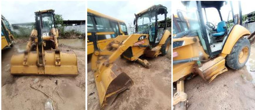
**SITUAÇÃO DA MÁQUINA:** FALTANDO UM DOS PNEUS, BANCOS DANIFICADOS, AVARIAS NA CARROCERIA, MECÂNICA DEFICIENTE E APARECIMENTO DE DEFEITOS O QUE NÃO PERMITE O USO ADEQUADO DA MÁQUINA, FICANDO PARADO POR GRANDES PERÍODOS. DEVIDO O ALTO CUSTO DE MANUTENÇÃO E OBJETIVANDO A RENOVAÇÃO DA FROTA FICAMOS DE ACORDO QUE A MÁQUINA DEVE SER LEILOADA.
