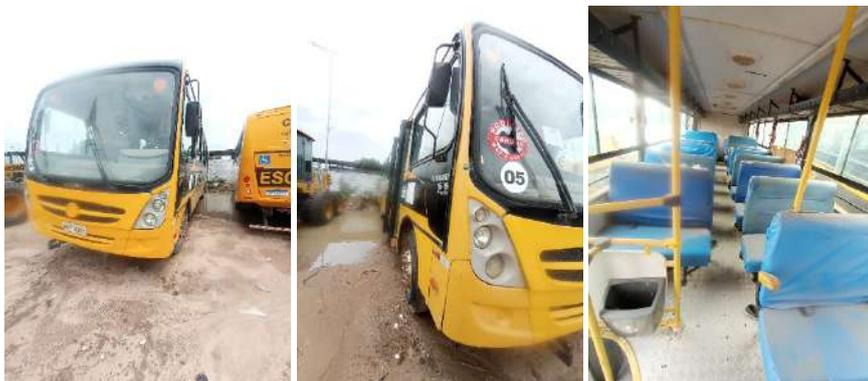
**SITUAÇÃO DO VEÍCULO:** AVARIAS NA CARROCERIA, BANCOS DANIFICADOS, PNEUS GASTOS, MECÂNICA DEFICIENTE E APARECIMENTO DE DEFEITOS O QUE NÃO PERMITE O USO ADEQUADO DO VEÍCULO, FICANDO PARADO POR GRANDES PERÍODOS. DEVIDO O ALTO CUSTO DE MANUTENÇÃO E OBJETIVANDO A RENOVAÇÃO DA FROTA FICAMOS DE ACORDO QUE O VEÍCULO DEVE SER LEILOADO.
