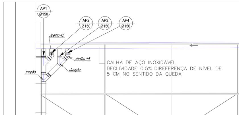
AMPLIAÇÃO DOS TUBOS DE COLETA DA CALHA
